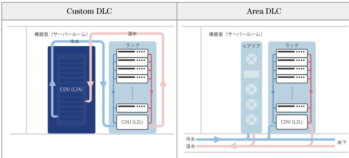
**Custom DLC:**ラック毎に冷水を供給。冷水温度やPhなど固有の条件に適した冷水を供給することが可能。
